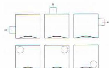
**Mögliche Einbauvarianten Ø 75/80 hinten:**
