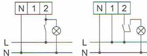
Achtung: für alle Schaltungsvarianten, ausgenommen einstufige Ausführung, ist zwingend ein 2-poliger Ein/Aus-Schalter zu verwenden (Rückspannung auf Klemme 2)
