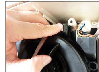
3. Montieren Sie die im Lieferumfang enthaltene Befestigungsabdeckung rechts oben mit der dazugehörigen Linsenschraube.
