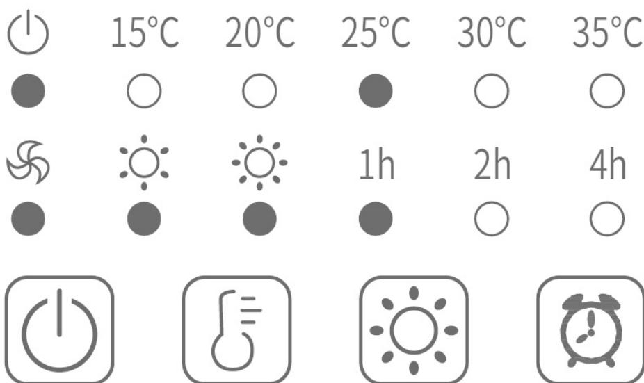
Après avoir branché le câble d'alimentation, le radiateur soufflant passe en mode Stand by et l'icône s'allume sur le panneau de commande.
