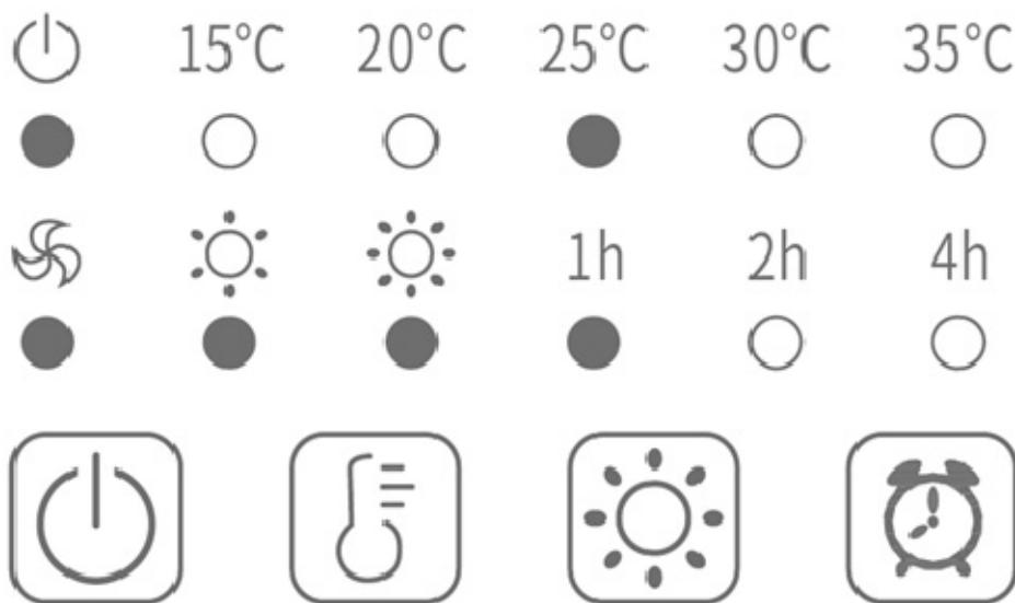
Nach dem Anschließen des Netzkabels wechselt die Lüfterheizung in den Standby-Modus und das Symbol leuchtet auf auf dem Bedienfeld.
