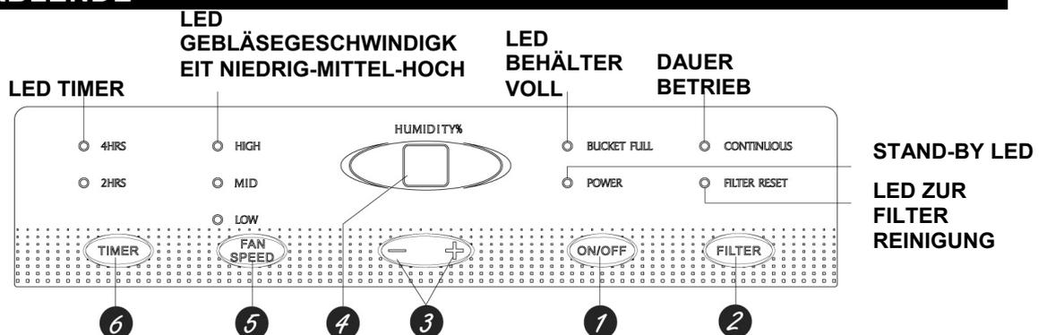
**1. TASTE ON/OFF:** Diese Taste zum Ein- und Ausschalten des Luftentfeuchters betätigen.
