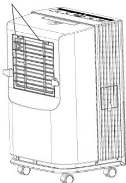
Der Filter hat die Aufgabe, in der Luft vorhandenen Staub und Druck herauszufiltern.
