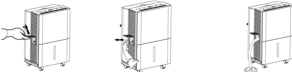
Öffnen Sie das an der Seite des Luftentfeuchters angebrachte Fach zur Abdeckung des Dauerabflusses.
