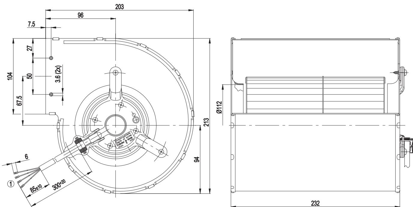
1 Anschlussleitung PVC 0.5mm<sup>2</sup>, 4x Aderendkrallen angeschlagen
