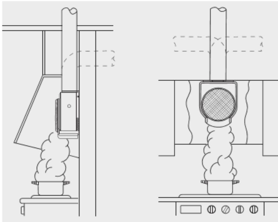
Um die maximale Effizienz der Absaugung zu erreichen, sollten die Ventilatoren der K-Serie in einer Herdhaube installiert werden. Der erforderliche Luftstrom hängt von der Haubenbreite und dem Abstand zwischen Haube und Kocher ab. Die Ventilatoren der K-Serie sollten in vertikaler Position mit der Fettauffangwanne nach unten installiert werden.
