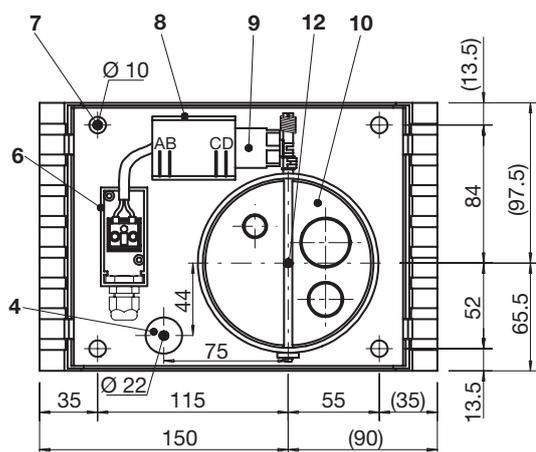
mit ausbrechbaren Rondellen für Grundvolumenstrom-Einstellung. Eingebauter elektrothermischer Antrieb mit spritzwassergeschützter Anschlussklemme. Das Luftdurchtrittsgitter ist zum Wechseln oder Reinigen des handelsüblichen Filters durch leichten Druck auf den Schnappverschluss abnehmbar.
