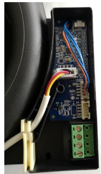
Bei Lüftern mit Feuchtesensor wird der Sensor durch ein 10 mm Loch im Filterträger gesteckt. Dazu befindet sich im Filterträger eine Sollbruchstelle, die mit Hilfe eines Schraubendrehers ausgebrochen werden kann. Der Feuchtesensor hält ohne zusätzliches Verkleben und ist in regelmäßigen Abständen (alle 3 Monate) auf Verschmutzungen zu prüfen.
