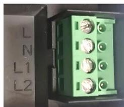
Für den 1-stufigen Betrieb muss eine Brücke zwischen den Eingängen L1 und L2 gesetzt werden. Diese ist beim 1-stufigen Betrieb zwingend notwendig. Für den 2-stufigen Betrieb wird keine Brücke benötigt.
