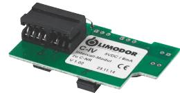
Le module d'intervalle C-IV embrochable s'adapte à tous les ventilateurs Limodor de la série M. Il propose des fonctions de contrôle supplémentaires en combinaison avec le module d'asservissement C-NR. Après avoir retiré le module de puissance, on monte ce module en le branchant tout simplement sur le C-NR.
